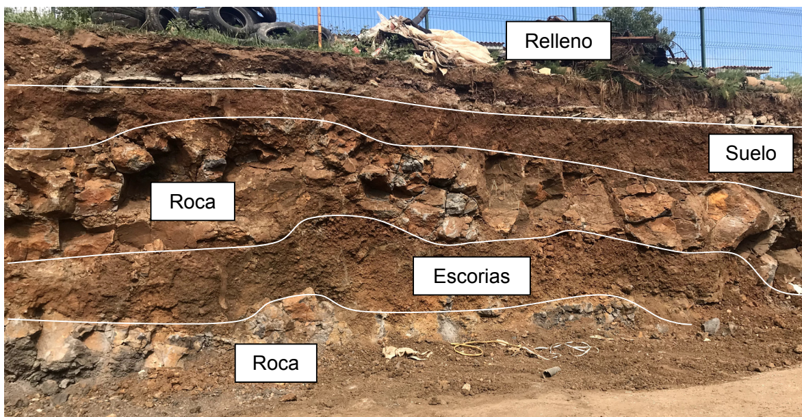
Foto 1. Talud NO de excavación de la zona de estudio.
