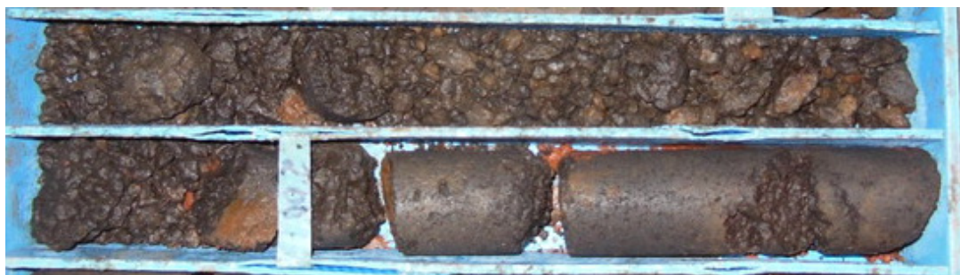
Foto 7 Aspecto que presenta el basalto microfracturado en el sondeo de la grúa, donde se puede observar la textura en grano de milllo.
